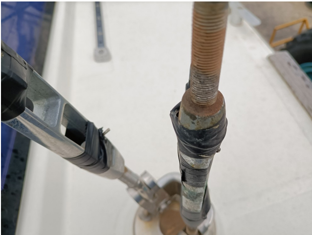
Figura 7: tenditore sartia alta deteriorato
